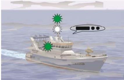
Figure 184 : signaux sonores d'un navire en train de pêcher avec ou sans erre par visibilité réduite
