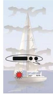
Figure 183 : signaux sonores d'un navire à voile avec erre ou erre par visibilité réduite
