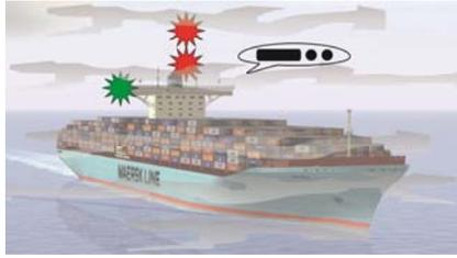
Figure 180 : signaux sonores d'un navire qui n'est pas maître de sa manœuvre avec ou sans erre par visibilité réduite
