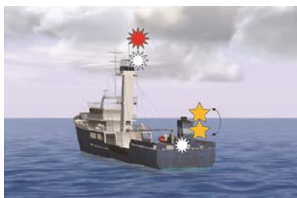
Figure 112 : senneur avec erre ; senne tournante déployée sur tribord
